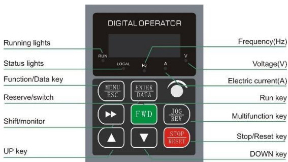
شکل 3-4 دیگرام پنل کنترل
