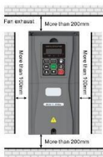
شکل 2-3 نصب چندین اینورتر
